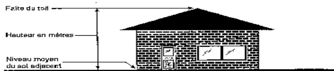
Croquis 4 : Hauteur en mètres d'un bâtiment
