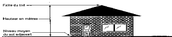
Croquis 4 : Hauteur en mètres d'un bâtiment
