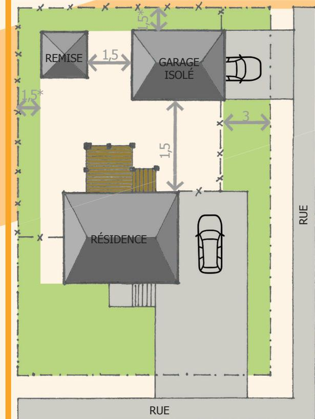
\*\* Les grandeurs indiquées sur les plans ci-haut sont des dimensions minimales en mètres. (À noter : 1 m = 3,28 pi)\*\*
